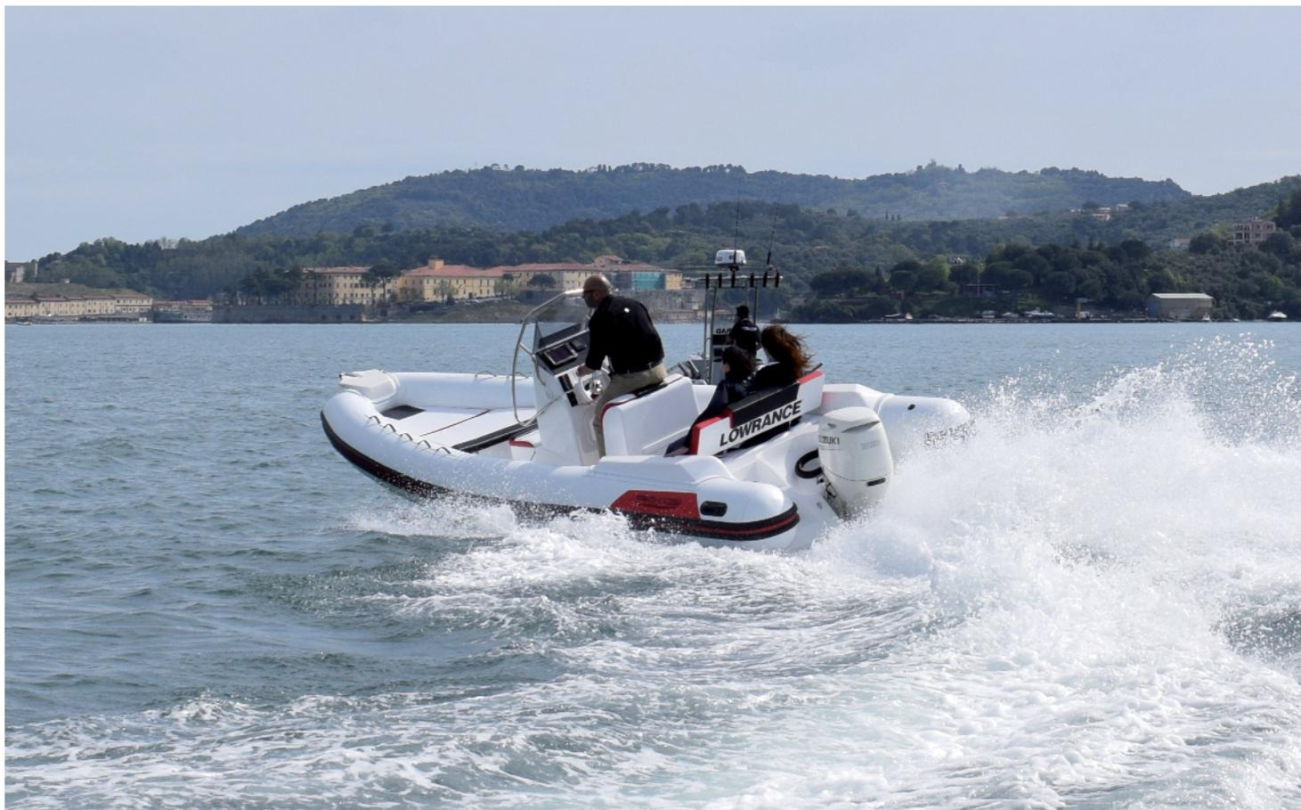
Il nuovo DF100B eredita l'architettura e la tecnologia dai modelli della famiglia DF-A di 70, 80 e 90 Hp. Rispetto al DF100A, la cilindrata della nuova unità di 100Hp passa da 2044cc a 1502cc, ed il peso a secco da 182Kg a 157Kg, valore che rende il DF100B tra i più leggeri della categoria, a favore delle prestazioni e dei consumi. L'unità termica è un 4 cilindri di 1502cc, alimentato a benzina con ciclo a 4 tempi e sistema d'iniezione elettronica multi-point.
